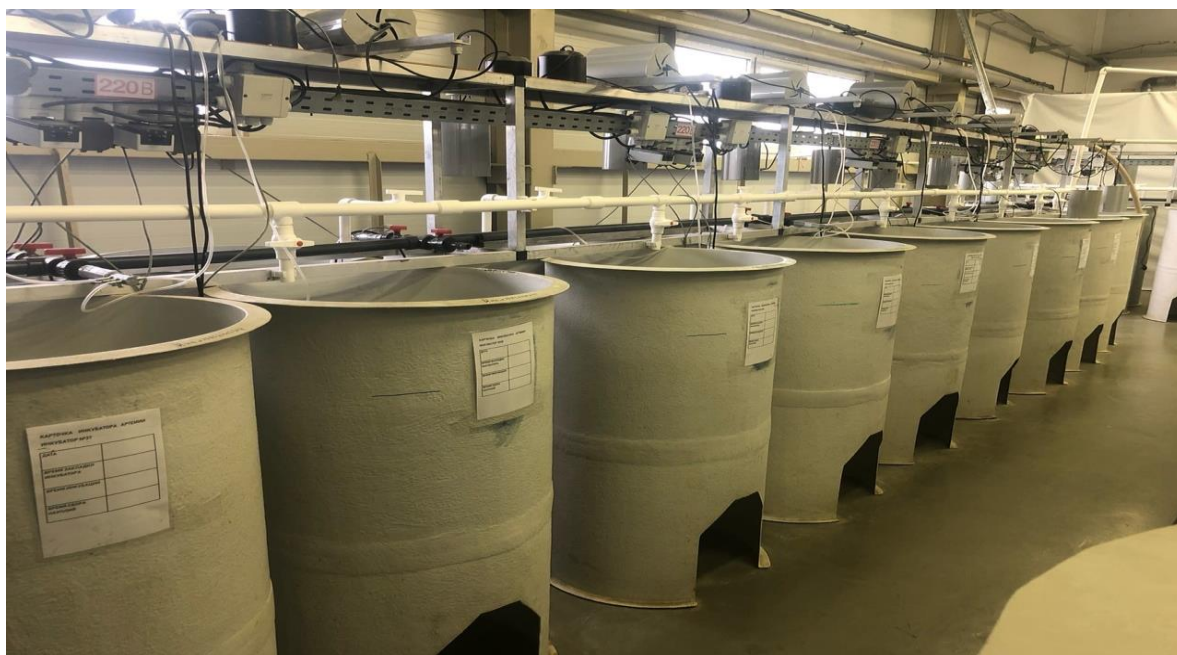
Рисунок 2 – Аппараты для инкубации цист артемии; АО ЮРЗ, 2020 г.
